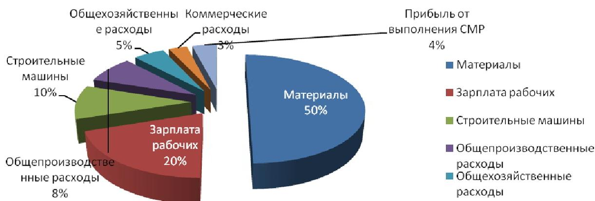
**Рисунок 2 – Условная структура выручки – строительные работы по объекту**
